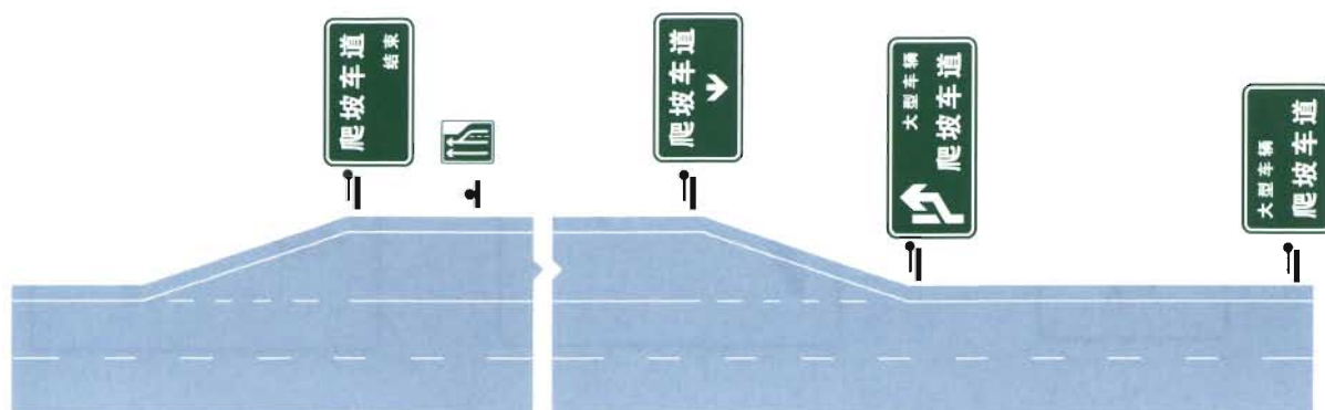
图 295 爬坡车道标志设置示例
